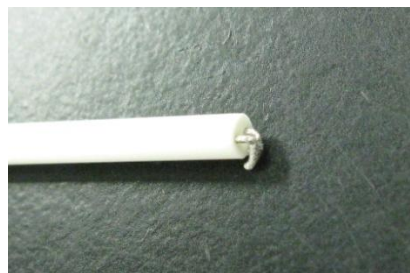
図 4 先端を溶接し、セラミック管に収めた白金・ロジウム-白金熱電対（稲熊研究室）。セラミック管には、各素線をとおす 2 本の穴があいている。
